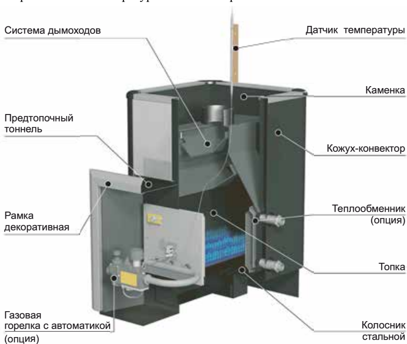
Рисунок-1. Конструкция печи.
